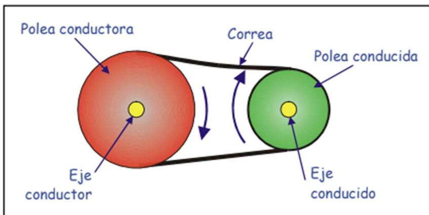
Puede resultar interesante observar que los dos tramos de la correa no se encuentran soportando el mismo esfuerzo de tensión: uno de ellos se encuentra bombeado (flojo) mientras que el otro está totalmente tenso dependiendo del sentido de giro de la polea conductora (en la figura anterior el tramo superior estaría flojo mientras el inferior estaría tenso).
